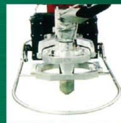
▲ 옵션으로 BEVEL 절단용 3D LINK도 장착 가능
