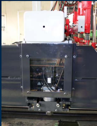
중축 구동부를 SADDLE의 중앙에 위치 축 고정부는 LM GUIDE 방식 적용으로 장비 운전시 발생하는 성능 개선
