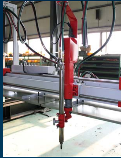
각바TYPE의 횡축 이동 SUB TORCH의 절단면 개선 및 유지보수 용이
